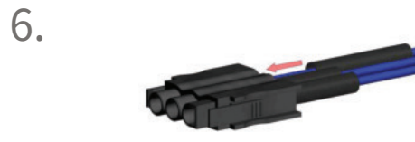
6. 将收缩管 (1) 滑到连接器外壳 (3) 上
