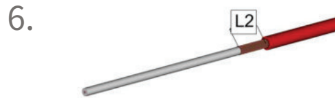
将屏蔽编织层切割大约 30 毫米 [1.181"] (=L2) ⚠小心地卸下屏蔽部件。屏蔽部件松动可能导致电气故障
