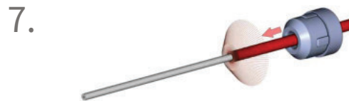
完全加宽屏蔽编织层。将密封插件 (2) 推入屏蔽编织层下方
