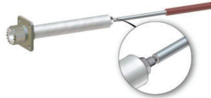
将触点 (8) 焊接到导体上 ⚠️ 接触面上不得残留锡焊料
