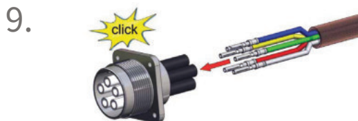
9. 将触点 (2) 完全滑入绝缘管，直至触点卡入到位。
