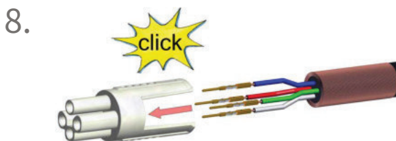
将触点 (1) 完全滑入绝缘部分 (2), 直至触点折断
